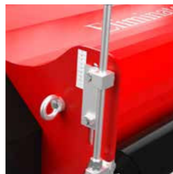
Einfache und genaue Einstellung der Arbeitstiefe.
