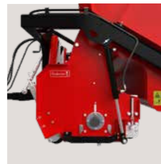
Schwimmender Kopf zur Bewältigung von Unebenheiten.
