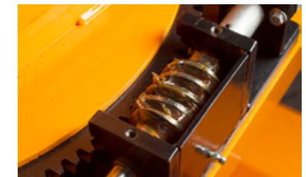
Alle Trejon Optimal Schneefräsen sind serienmäßig mit einem selbstreinigenden Schneckengetriebe ausgestattet, das den Auswurfkamin in der gewünschten Arbeitsstellung hält.
