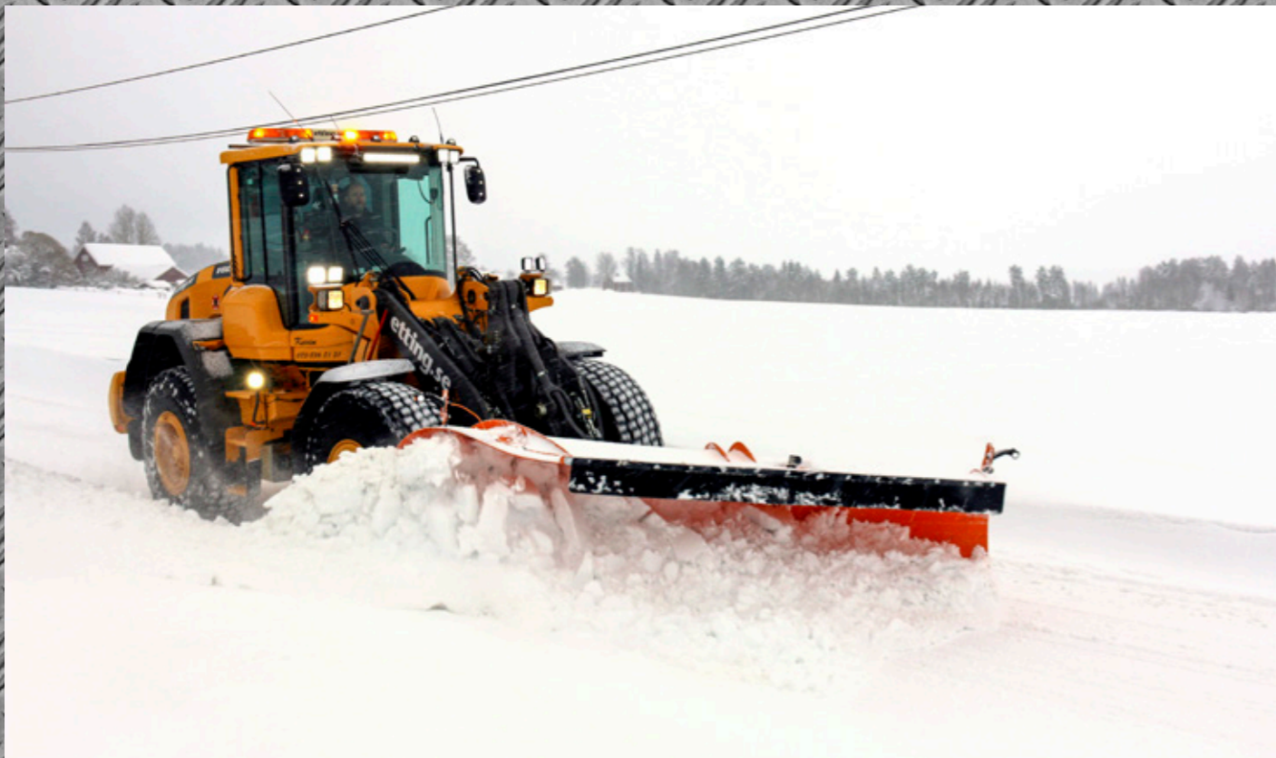
Stark positiver Anstellwinkel für sauberes Räumen bei hohen Geschwindigkeiten.
