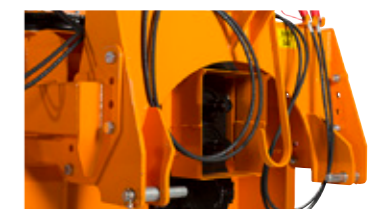
3-Punkt-Anbau, Front- oder Heckmontage.
