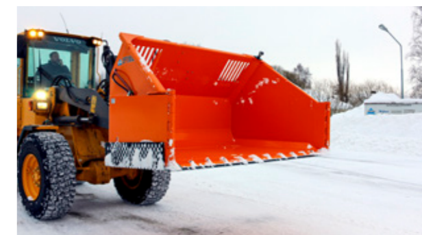
Die Räumschaufel hat eine immense Aufnahmekapazität, und dank der konischen Form mit abgerundeter Rückseite fällt der Schnee beim Entleeren/Kippen leichter heraus.
