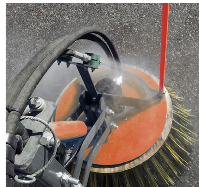
Das Hochdrucksystem (hier im Bild) reduziert die Gesamtmenge an PM10-Partikeln in der Luft um bis zu 52 %. Wassernebel bindet den Staub wirksam, ohne die Fläche zu benetzen und damit Wasser zu verschwenden.
