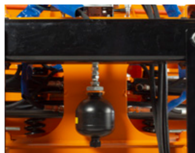
Die elektrische Steuerung des Ventilblocks, sowie ein Akkumulator als Kollisionsschutz sind bereits Grundausstattung,
