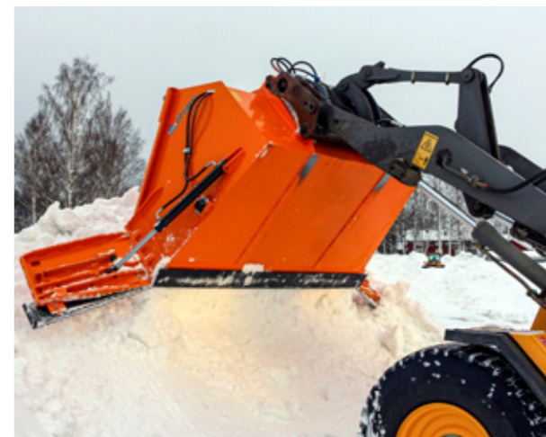
Die Räumschaufel hat eine immense Aufnahmekapazität, und dank der konischen Form mit abgerundeter Rückseite fällt der Schnee beim Entleeren/Kippen leichter heraus.
