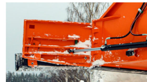
Trejon Optimal klaffskopa har hydrauliska sidoklaffar som kan vikas 75 grader framåt och 90 grader bakåt. Klaffarna har också flytande slitstål som följer marken.
