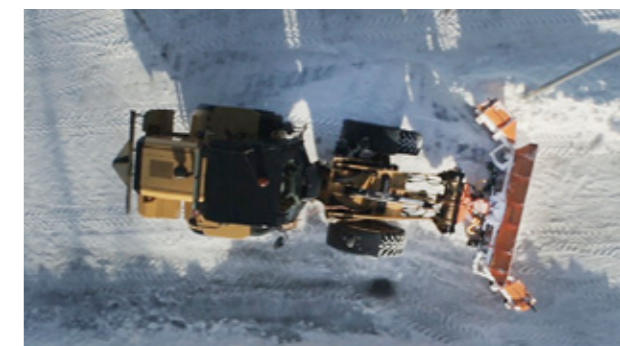
An Hindernissen wie Laternen und geparkten Autos können Sie nahtlos weiterarbeiten und diese mit dem Trejon U-Pflug aussparen.
