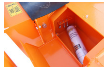
Ein Werkzeugkasten mit Halter für Scherbolzen ist Standard bei allen HD- und hydraulischen Modellen. Er bietet Platz für Scherbolzen, Werkzeug, Schmierausrüstung usw.
