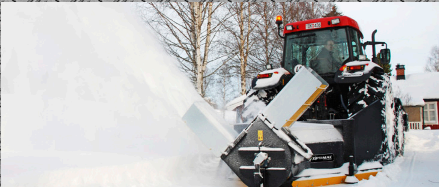
Trejon Optimal 225-2 mit einer Arbeitsbreite von 225 cm und doppeltem Auswurf
