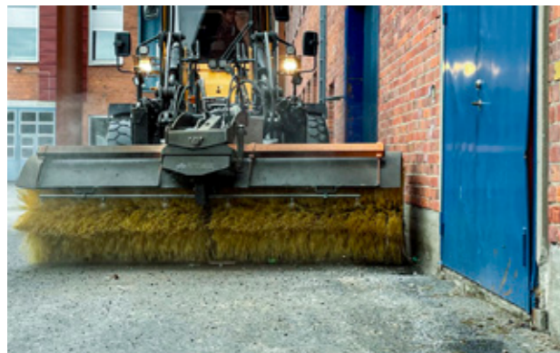
Der Kettenantrieb im Zentrum der Maschine macht es möglich, ganz nah an Gebäuden zu kehren.
