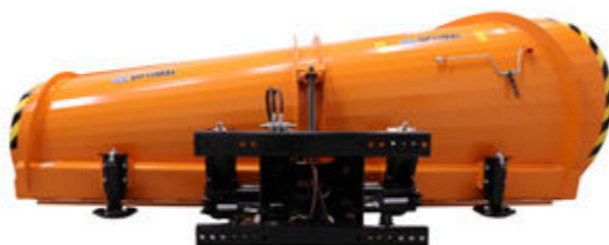
Pflug und Leiste pendeln gleichzeitig nach oben/unten.
