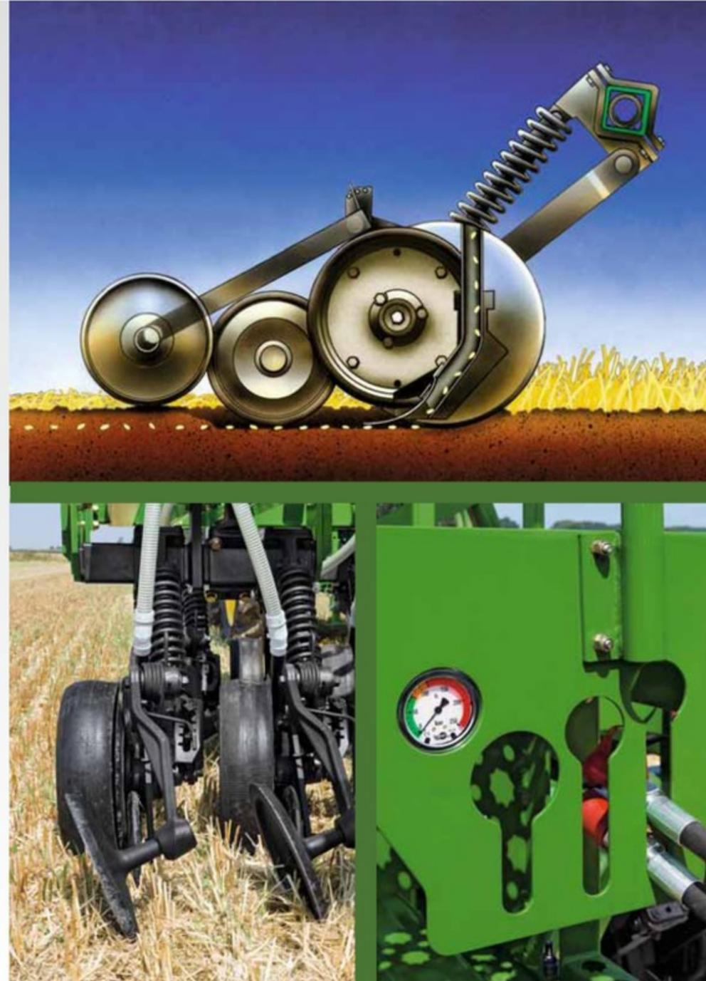
Präzise Saatgutablage. Die Scheibenschare mit 457 mm Durchmesser haben einen Anstellwinkel von 7°. Das fördert eine geräumte Saatrille und stört das Bodengefüge nur minimal.
