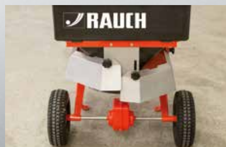
Streubreite rechts/links separat einstellbar
