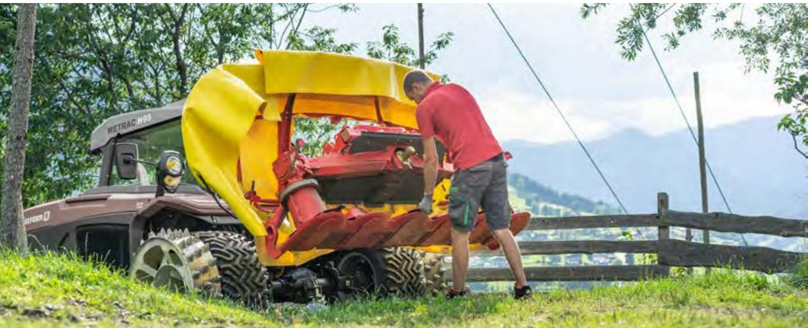
Durch die großzügige und einfach bedienbare Schutzklappung ist die Zugänglichkeit zum Mähbalken von allen Richtungen optimal gelöst. Ähnlich wie bei einer Motorhaube ist beim NOVACAT F ALPIN der gesamte Schutz mit nur einem Handgriff aufklappbar. Kraftvolle Gasdruckdämpfer unterstützen Sie dabei und halten den Schutz in geöffneter Position. Einem schnellen Klängenwechsel steht nichts im Weg.
