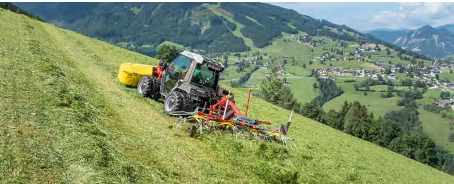
Die beiden HIT V ALPIN Modelle mit vier Kreiseln sind absolute Leichtgewichte. Je nach Modell bringt der Zetter mit starrem Anbaubock lediglich 320 kg auf die Waage. Beim Modell mit Schwenkbock sind es nur 390 kg. Beide Zetter erreichen eine Arbeitsbreite (DIN) von 4,20 m.
