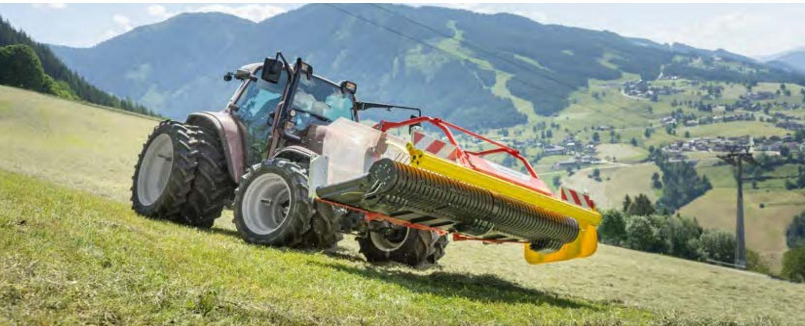
Drei Gleitkufen tasten den Boden ab und führen den Bandschwader perfekt über jede Bodenunebenheit. Die Rechhöhe kann über Distanzscheiben voreingestellt und über die Länge des Oberlenkers feinjustiert werden. Die Entlastung des Mergers funktioniert entweder über die Geräteentlastung der Hubwerksregelung oder optional über zwei starke Zugfedern zwischen Anbaubock des Bandschwaders und Konsole am Traktor.
