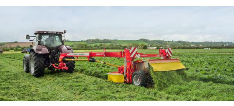
Unsere gezogenen Mähwerke NOVACAT T mit 3,04 m / 3,46 m Arbeitsbreite eignen sich optimal für den Einsatz mit kleinen Traktoren. Durch die gezogene Variante mit Fahrwerk benötigen Sie keine Hubkraft, wodurch Sie auch weniger leistungsstarke Traktoren einsetzen können. So sparen Sie Kraftstoff.
