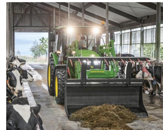
Fahren Sie bei Bedarf besonders langsam und konstant. Der Kriechgangsatz erlaubt eine extrem niedrige Arbeitsgeschwindigkeit von nur 280 m/h.
