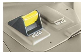
Mit der elektrohydraulischen Zapfwellenbetätigung schalten Sie bequem per Schalter die Zapfwelle zu und ab.
