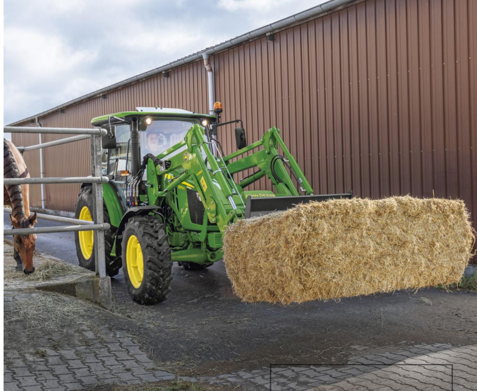
Der zuverlässige, stabile Premium-Frontlader H240 ist passgenau auf Ihren 5E zugeschnitten. Seine optimal dem 5E angepasste Geometrie stellt sicher, dass das Gewicht gleichmäßig auf den gesamten Traktorrahmen und die Vorderachse verteilt wird. Das erklärt, warum der 5E zusammen mit dem H240 ein derart stabiles Gespann bildet. Dazu haben Sie die Wahl zwischen Frontlader mit mechanischer Parallelführung (MSL) und ohne Parallelführung (NSL).
